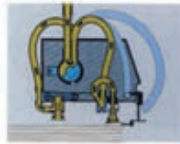
کنترل هوای مکشی
