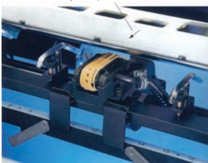
شکل ۳۳-۴ — سیستم سرعت‌گیر ورق چاپی
