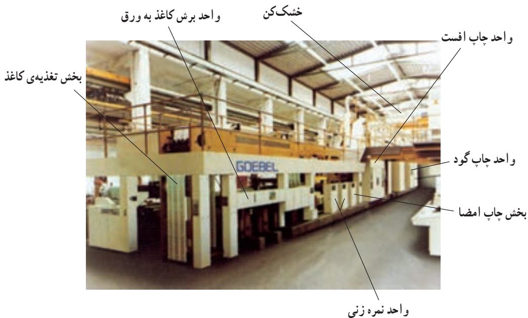
شکل ۲-۳- دستگاه چاپ اسکناس با واحد تغذیه ی کاغذ رول گوبل
