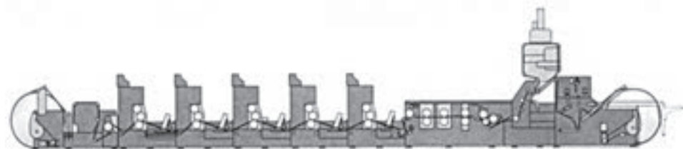
شکل ۱۴-۳- دستگاه چاپ شش رنگ uv مولر مارتینی Muller_Martini
