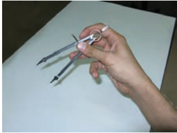
شکل ۲-۴- تنظیم دهانه‌ی پرگار تقسیم
