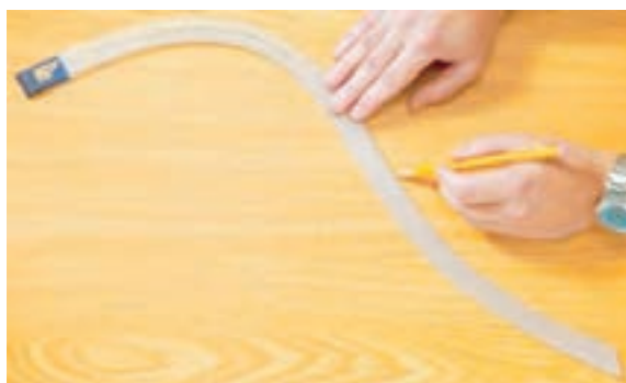
شکل ۴-۱۴- کار با منحنی کش ماری
