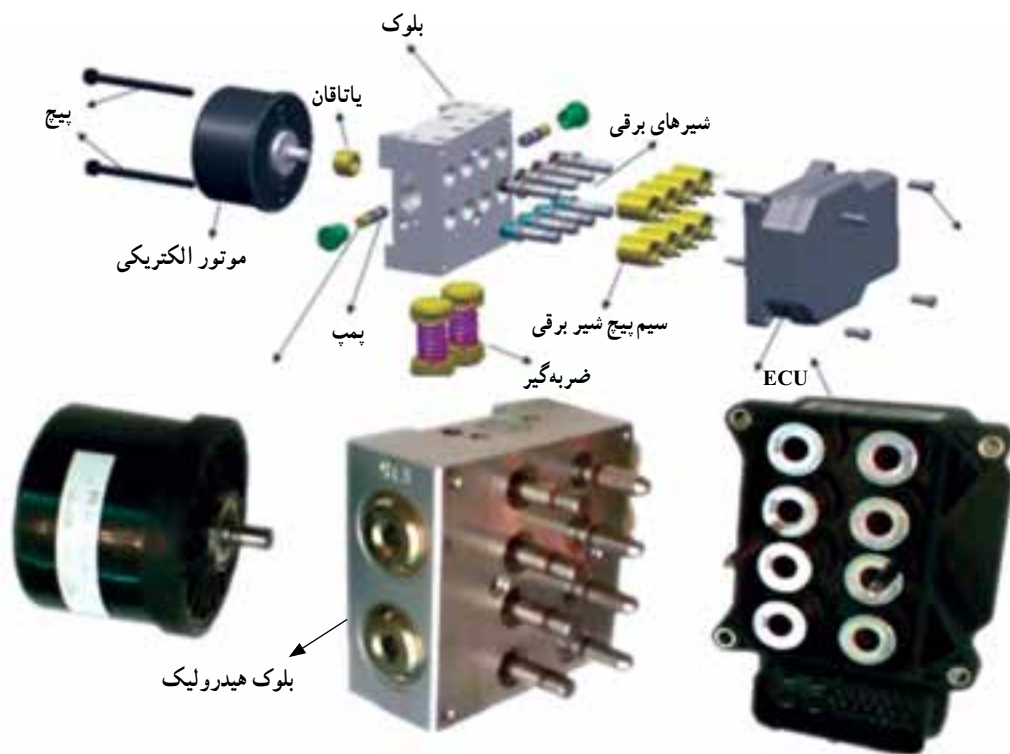
شکل ۱۱-۱۱- بلوک هیدرولیک سیستم ترمز ضد قفل (ABS)
