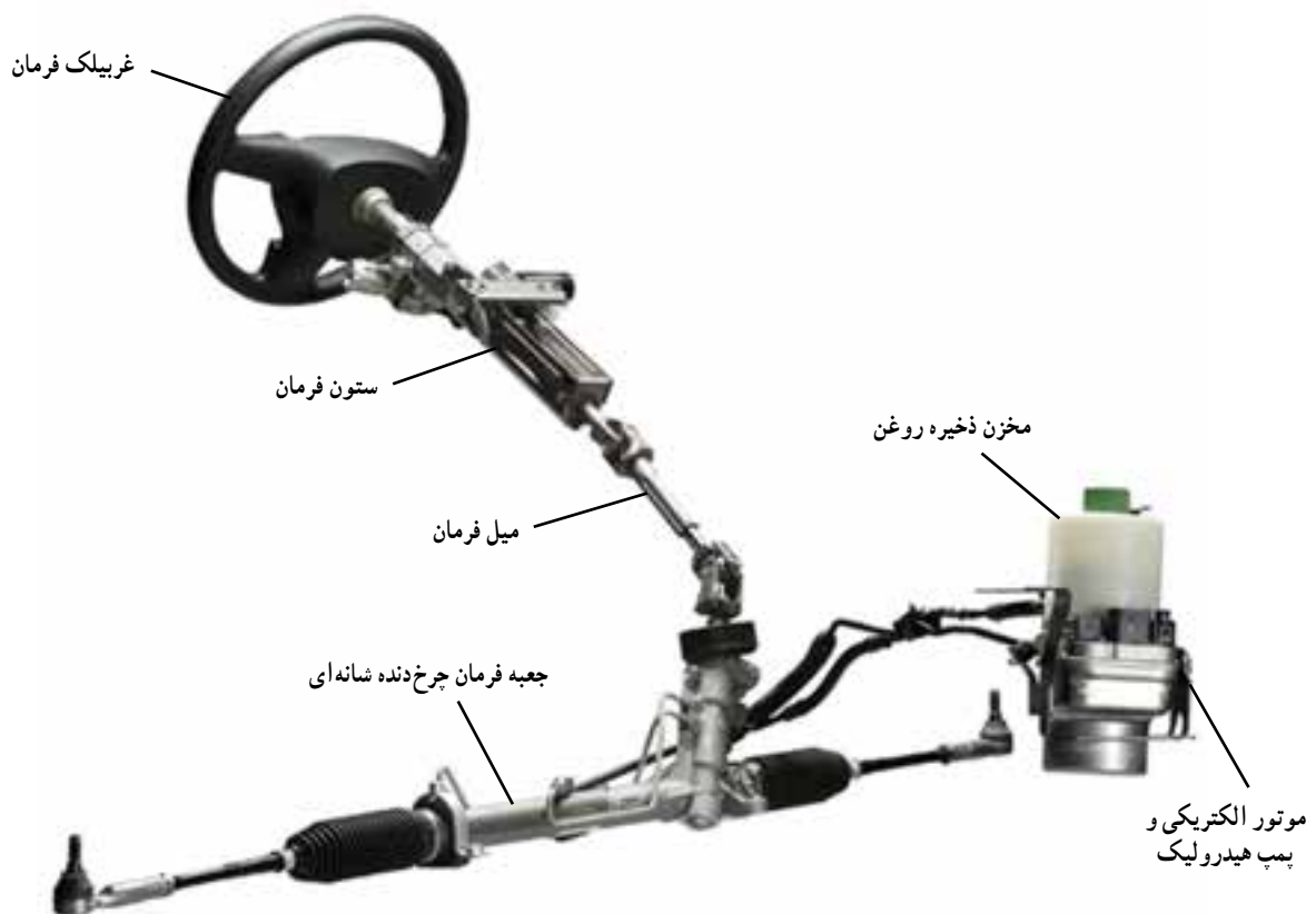
شکل ۱۹-۸- ساختمان ظاهری فرمان الکترو هیدرولیکی
