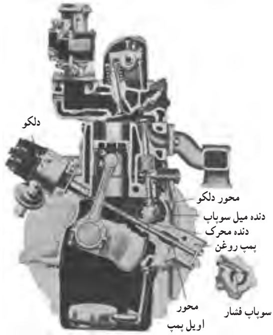
شکل ۱۳-۴- اويل پمپ خارج از موتور قرار داشته و از ميل سوپاپ نيرو مي گيرد.
