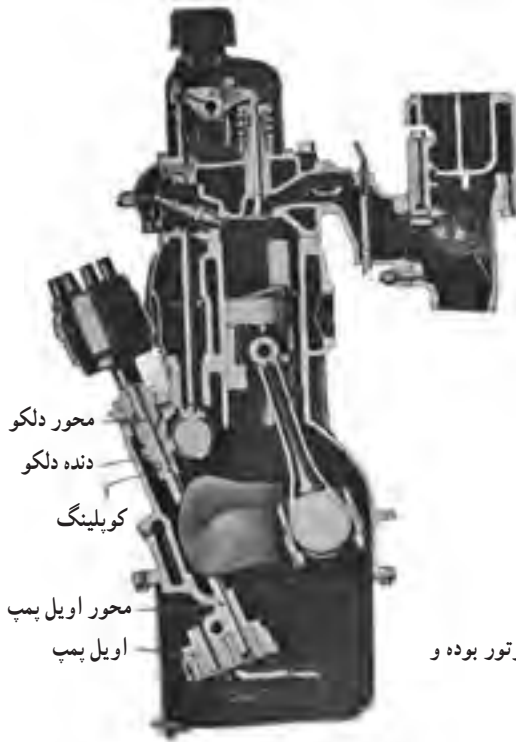
شکل ۱۳-۴- اويل پمپ خارج از موتور قرار داشته و از ميل سوپاپ نيرو مي گيرد.
