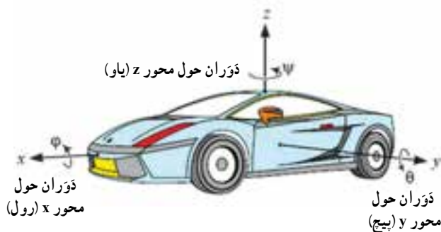
شکل ۷-۲- سیستم مختصات خودرو
