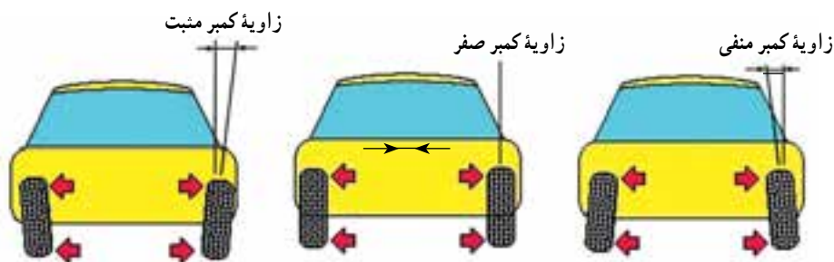
شکل ۱۰-۷. حالت‌های مختلف زاویه کمر چرخ
