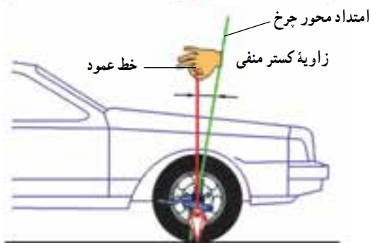
شکل ۷-۱۳- انواع حالت‌های زاویه کستر
