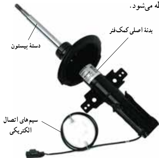
شکل ۷-۲۴- ساختمان ظاهری کمک فنر قابل تنظیم پیوسته از نوع ام آر (MR)
