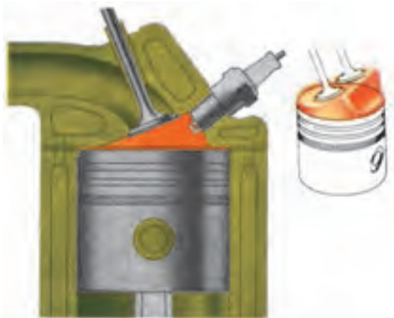
شکل ۱۰-۳- در این فرم اتاق احتراق (گوه‌ای شکل)، شعله بهتر پیشروی می‌کند.
