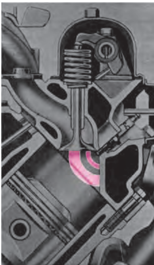
شکل ۳-۸- نمایش احتراق عادی که از طرف شمع شروع می‌شود.
