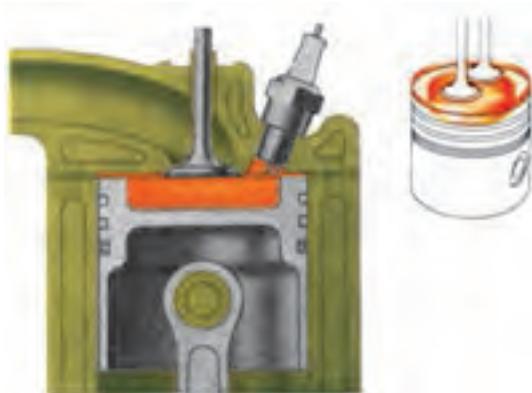
شکل ۱۲-۳- اتاق احتراق در کف پیستون، در این طرح موتور بهتر تنفس می‌کند.
