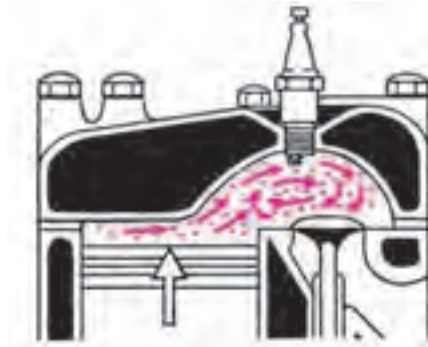
شکل ۱۵-۳- چرخش گاز در اتاق احتراق که اختلاط بهتری بین بنزین و هوا فراهم نموده، راندمان احتراق را افزایش می‌دهد.
