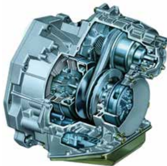
شکل ۵-۸- سی وی تی مجهز به پولی با شعاع متغیر
