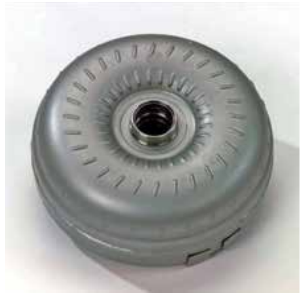
شکل ۵-۱- نمای ظاهری مبدل گشتاور
