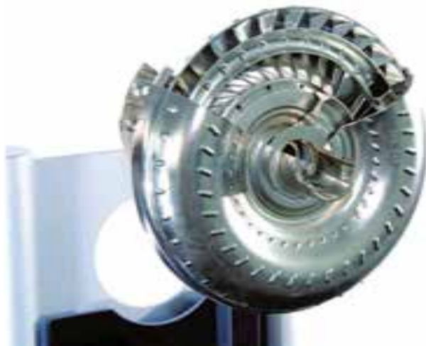
شکل ۵-۲- اجزای داخلی مبدل گشتاور
