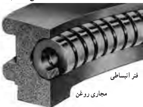
شکل ۲-۴۴- شکل قرار گرفتن رینگ‌ها در پیستون
