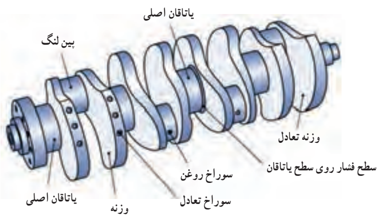
شکل ۲-۶۵- فرم میل لنگ و اجزای آن
