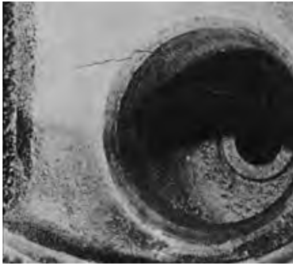
شکل ۲-۲۱- ترکیدن سیت سوپاپ
