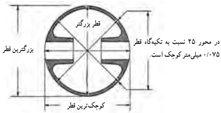
شکل ۳۵-۲ پیستون بیضی شکل
