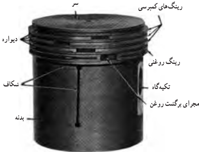
شکل ۴۱-۲- پیستون با چهار رینگ
