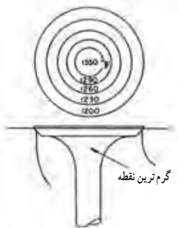
شکل ۲-۲۲- توزیع درجه حرارت در سوپاپ دود (F) در شرایط عادی
