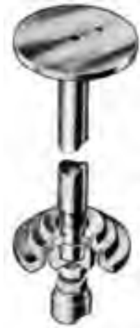
شکل ۲۵-۲- ساختمان سوپاپ گردش آزاد
