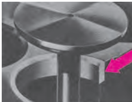
شکل ۱۹-۲- سیت سوپاپ اغلب از مواد سخت ساخته می شود و به طور برسی نصب می گردد.
