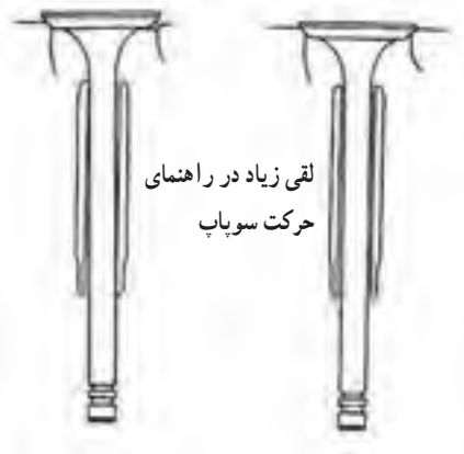
شکل ۱۷-۲- لقی زیاد گیت (راهنما) باعث کج نشستن سوپاپ می‌شود.
