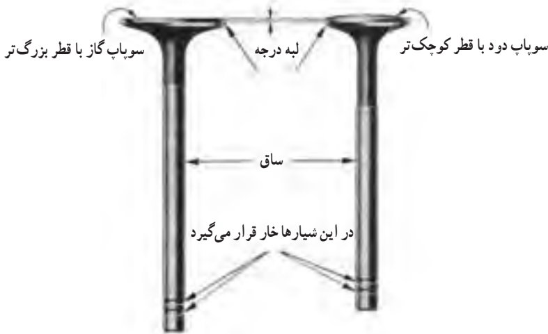
شکل ۲-۱۵- شکل سوپاپ و لبه های آن در آب بندی گاز تأثیر مهمی دارد.
