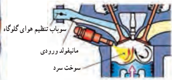
شکل ۲۰-۱- اشکال مختلف محفظه احتراق به منظور اختلاط بهتر سوخت و هوا
