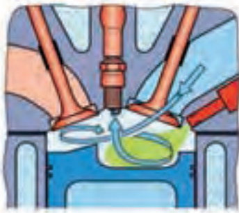
شکل ۲۰-۱- اشکال مختلف محفظه احتراق به منظور اختلاط بهتر سوخت و هوا
