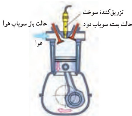
شکل ۱-۱۵- کورس مکش موتور، در این مرحله سوپاپ گاز باز و دود بسته است.
