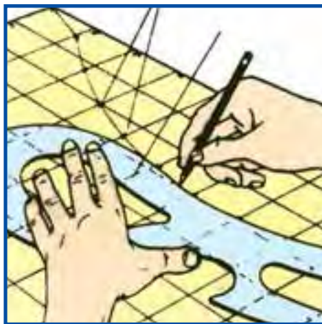
شکل ۳-۳- تطبیق پیستوله با منحنی رسم شده
