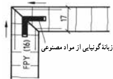
شکل ۲-۶۶- ترسیم علائم اتصال قلیف زبانه سراسری از جنس مواد مصنوعی
