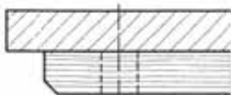
شکل ۸-۲- ترسیم هاشور راه چوب و سرچوب ماسیو پیچ شده
