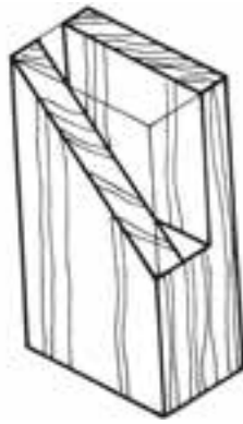
شکل ۱-۲۹- تصویر مجسم ایزومتریک قطعه فاق به صورت کامل شده
