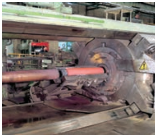
شکل ۸-۲۶- اعمال فشار توسط پرس هیدرولیک به فلز گداخته در فرآیند اکستروژن
