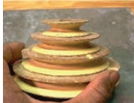
شکل ۲-۸- تهیه مدل ریخته‌گری ماسه‌ای
