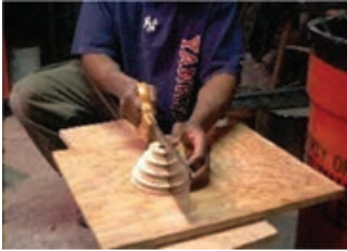
شکل ۲-۸- تهیه مدل ریخته‌گری ماسه‌ای
