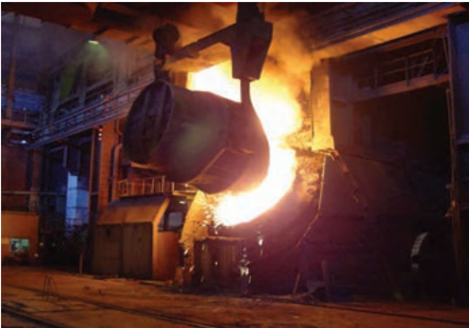
شکل ۴-۷- اضافه کردن عناصر آلیاژ به کوره فولادسازی
