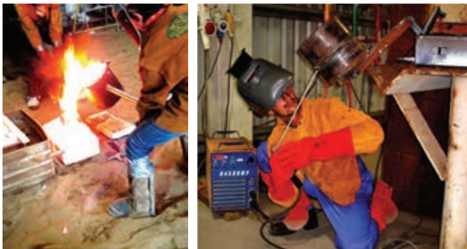
شکل ۳-۱۴ ذوب ریزی درون قالب ریخته گری
