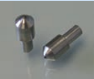
شکل ۲۱-۳- نمونه‌ای ابزار فرورونده جهت اندازه‌گیری سختی
