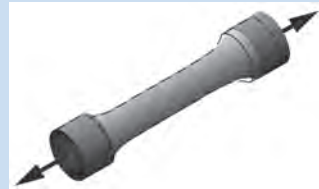
شکل ۱۶-۳- نمونه تست کشش طبق استاندارد ASTM A۳۷۰
