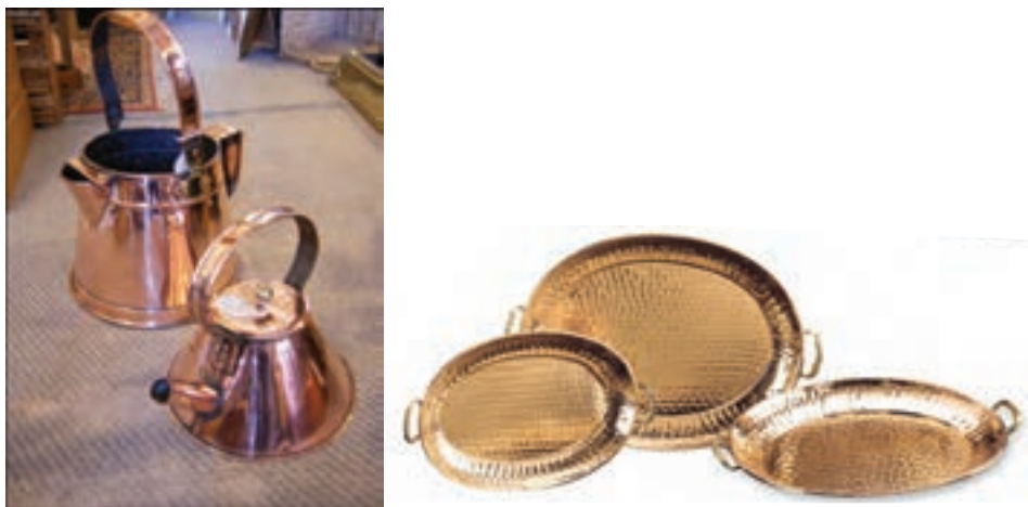
شکل ۱۳-۳- ظروف مسی ساخته شده به وسیله چکش کاری
