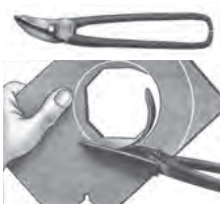
شکل ۲-۶ نمونه‌ای از قیچی داخل بُر و شیوه‌ی کار با آن
