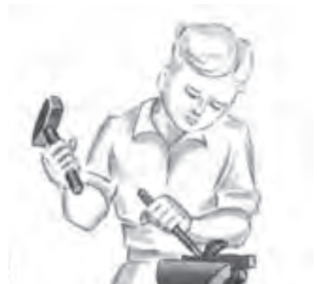
الف) قلم کاری نادرست
