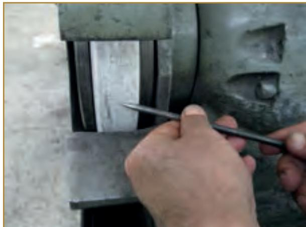
شکل ۹-۱۴- تیز کردن سوزن خطکش
