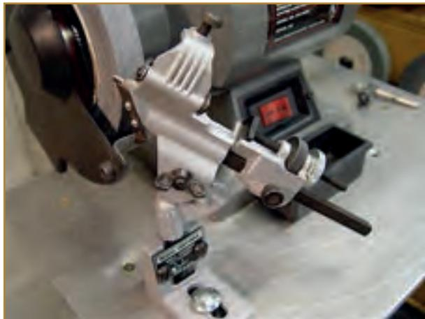
شکل ۹-۱۹- تیزکردن مته به کمک ابزار مخصوص
