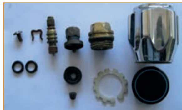
شکل ۲-۸ پیاده کردن قطعات شیر آب
