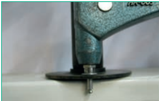
شکل ۷-۱۳- جا زدن پرچ داخل سوراخ
