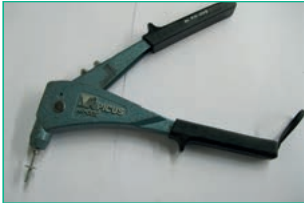
شکل ۷-۱۲- جا زدن پرچ روی انبر پرچ
