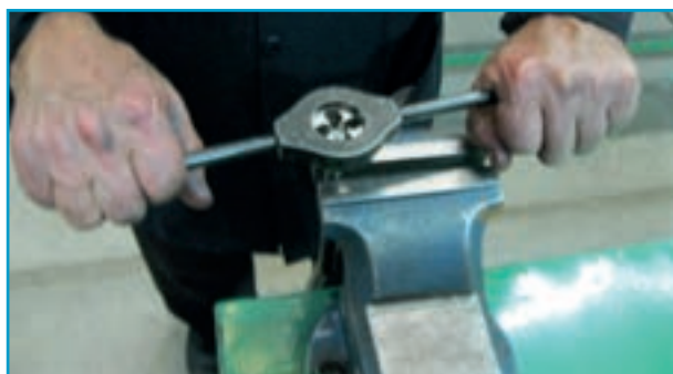
شکل ۶-۱۲ - نحوه اعمال نیرو در حدیده‌کاری
