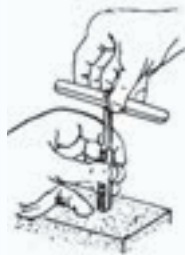
شکل ۶-۲۷ - قلاویز کاری سوراخ بن بست
