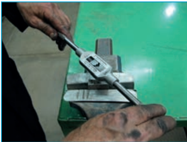
شکل ۶-۲۲- جا انداختن قلاویز
