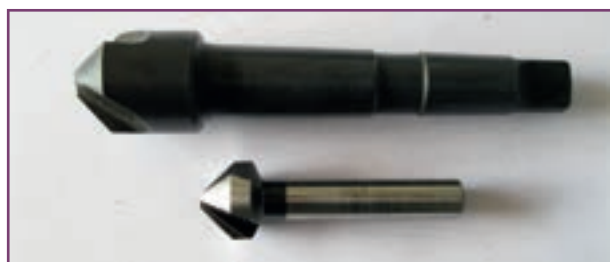
شکل ۱۵-۵- مته‌خزینه‌های دنباله مخروطی و دنباله استوانه‌ای
