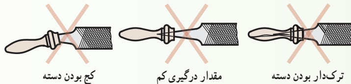
شکل ۲۳-۴ - نامناسب بودن دسته سوهان
