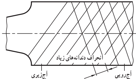
شکل ۴-۹- وضعیت آج‌ها با زوایا و گام‌های مختلف
