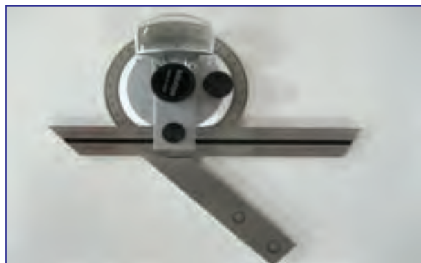
شکل ۱-۴۹- زاویه سنج اونیورسال ۵ دقیقه
