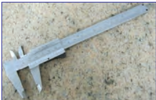
شکل ۱-۴۶- کولیس ورنیه
