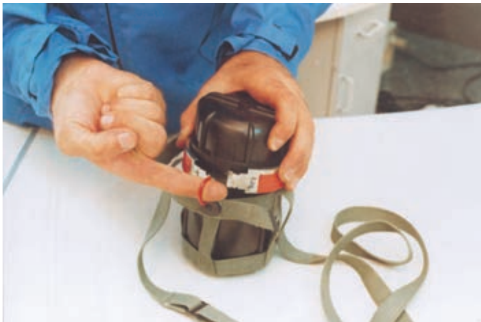
شکل ۵-۱۱- باز کردن پمپ درب خودنجات
