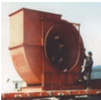
شکل ۲-۹- وانتیلاتور گریز از مرکز
