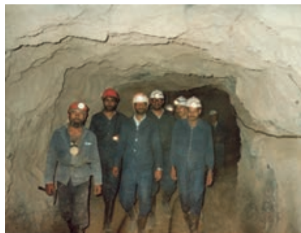
شکل ۹-۱۰- چراغ‌های تونلی انفرادی
