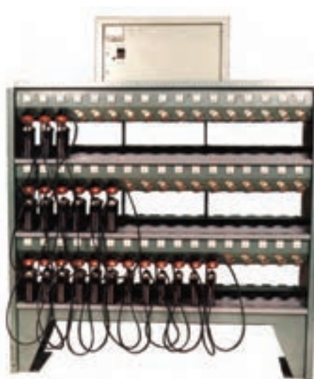
ب - دستگاه شارژ باتری
