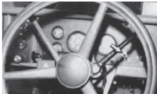
شکل ۴۶-۶- بررسی و کنترل ترمز ثانویه
