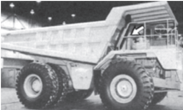
شکل ۳۰-۶- محل مخزن روغن سیستم فرمان
