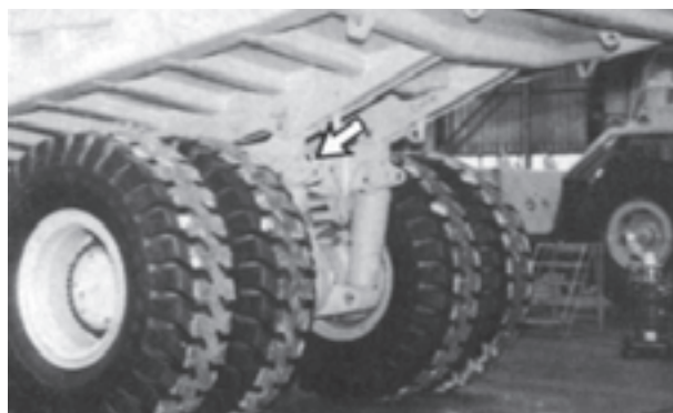
شکل ۴۸-۶ آزمایش زنگ خطر دنده عقب
