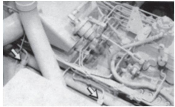
شکل ۲-۶-۷۰- مهره لوله سوخت در ورودی انژکتور
