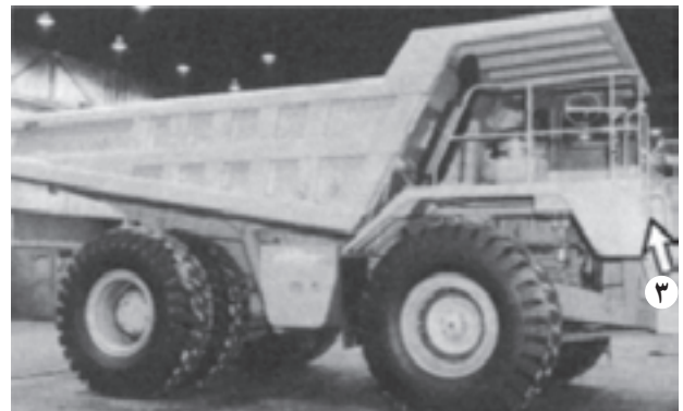
شکل ۳۳-۶- بررسی وضعیت چراغ‌ها از نظر آسیب دیدگی
