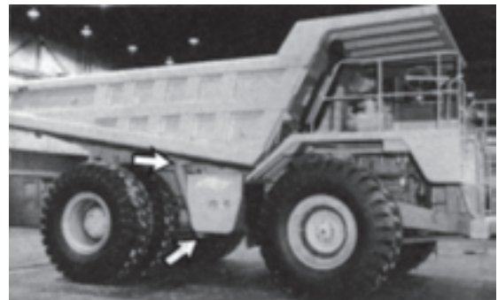
شکل ۶-۷۱- پیچ تخلیه محفظه فیلتر
