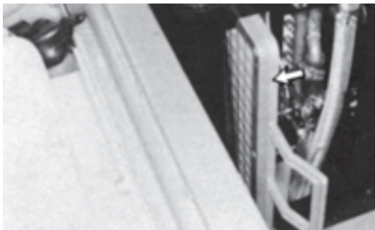
شکل ۵۲-۶- باز کردن در مربوط به فیلتر کولر
