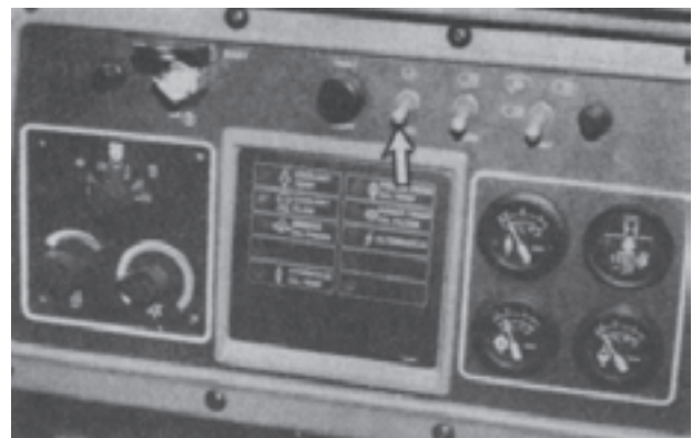
شکل ۳-۵- کلید آزمایش سیستم هشداردهنده
