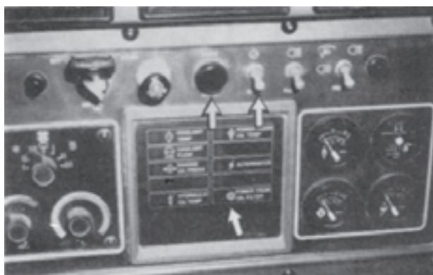
شکل ۵-۴۹ - آزمایش سیستم هشداردهنده
