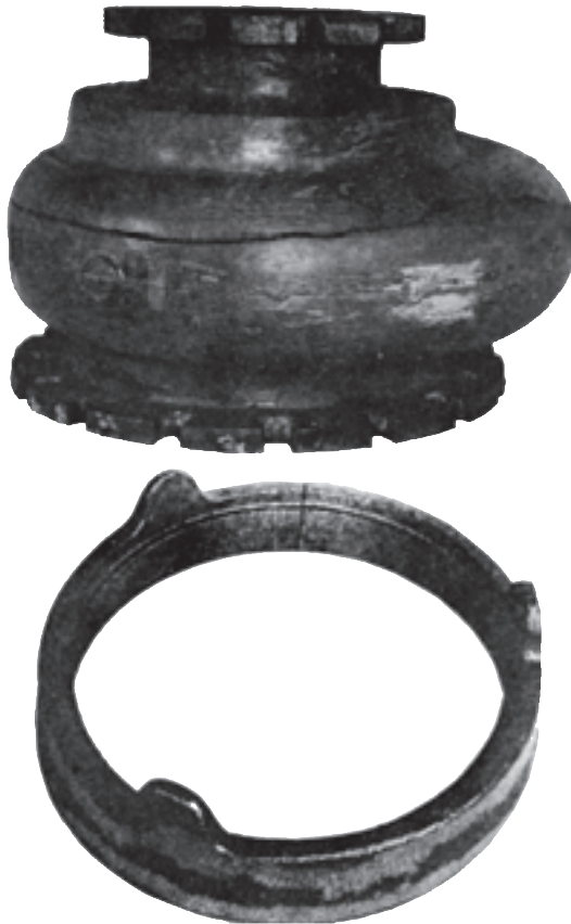
شکل ۹-۱۲- ترک سرد حاصل از مقاومت ماهیچه در مقابل انقباض فاز جامد
