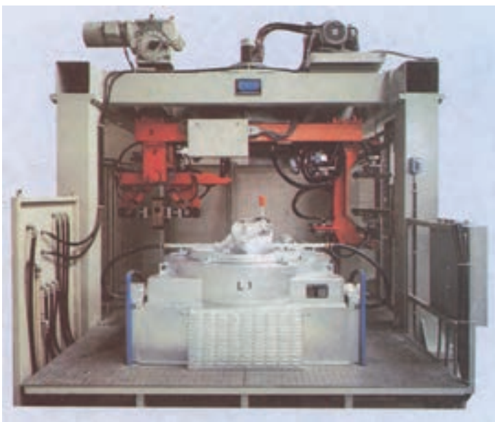
شکل ۱۰-۷- ماشین ریخته‌گری تحت فشار کم
