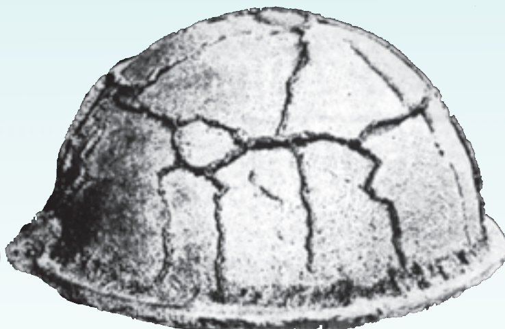
ب — پلیسه به دلیل ترک قالب ناشی از خاک و ذرات بسیار ریز در ماسه
