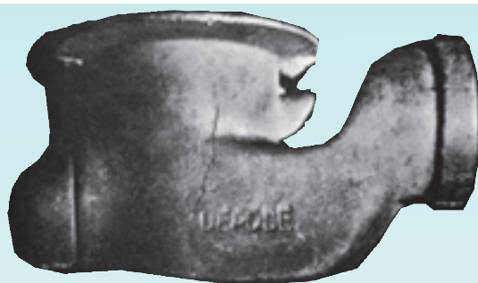
الف — ترک گرم در فولاد به دلیل استحکام ماهیچه
