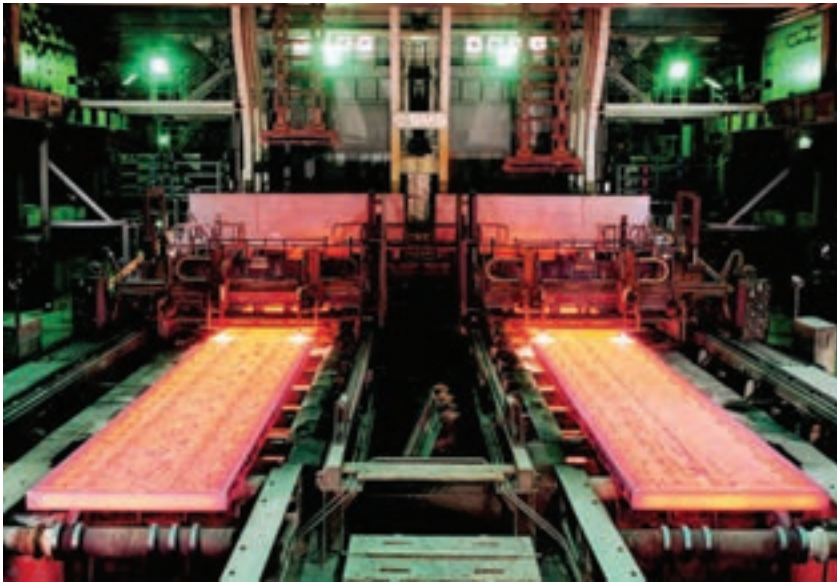
شکل ۸-۱- دستگاه نورد ۱۶۰ اینچی کارخانه‌ی Homestead که به وسیله‌ی محافظ‌هایی شمش از طرفین کنترل می‌شود تا عریض نشود و گوشه‌های آن قائم بماند.
