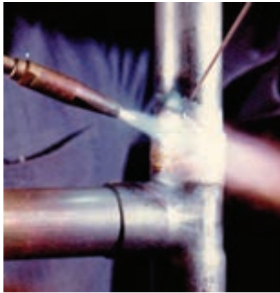
شکل ۱۸-۱- تکنیک جوشکاری به روش اکسی استیلن
