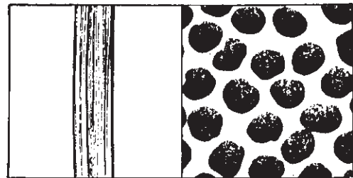
شکل ۴-۶- مقطع عرضی و نمای طولی الیاف ویسکوز قوی شده
