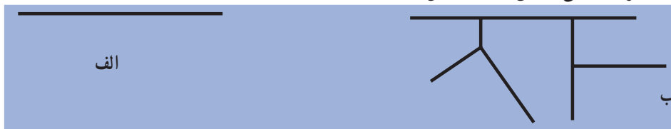
شکل ۱-۵- الف - پلیمر مناسب برای لیف شونده ب - پلیمر نامناسب برای لیف شونده
