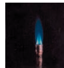
پ) یک چراغ پونزن با شعله آبی که در آن فرآیند سوختن گاز به طور کامل انجام می‌شود.
