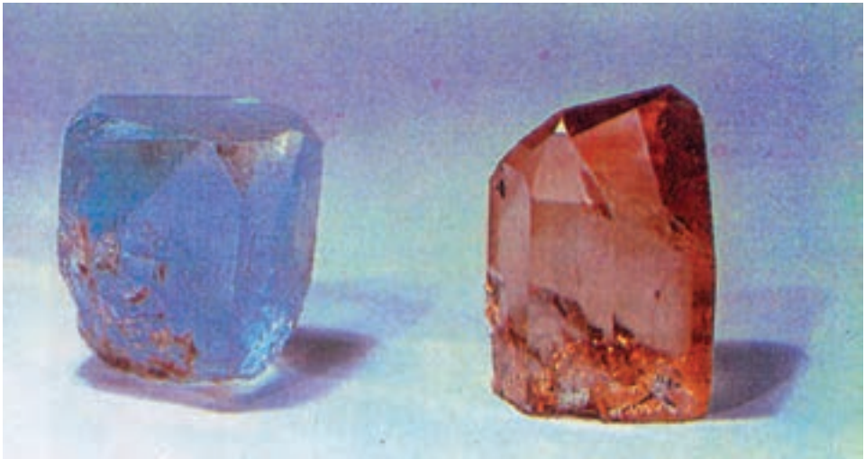
شکل ۹-۲- توپاز آبی و قهوه‌ای کمرنگ (Topaz) به فرمول شیمیایی Al_2[SiO_4](F,OH)_2 و ساختار کریستالین اورتورومبیک
