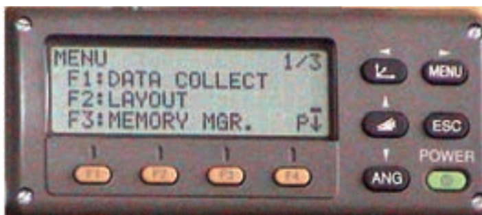
▲ شکل ۶-۱۴- ورود به منوی DATA COLLECT
