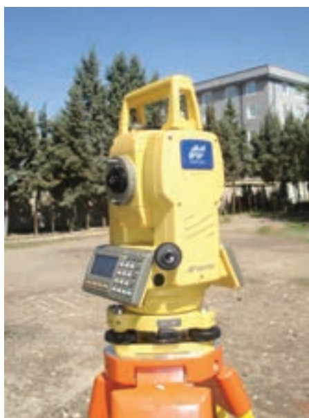
▲ شکل ۳-۶- توتال استیشن Topcon سری GTS - ۲۳۰
