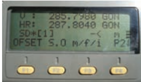
▲ شکل ۳-۳- صفحه اول منوی طول‌یابی در توتال استیشن Topcon سری GTS-۲۲۰
