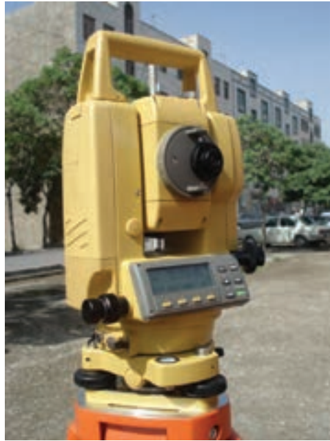
▲ شکل ۳-۴- توتال استیشن Topcon سری GTS - ۲۲۰
