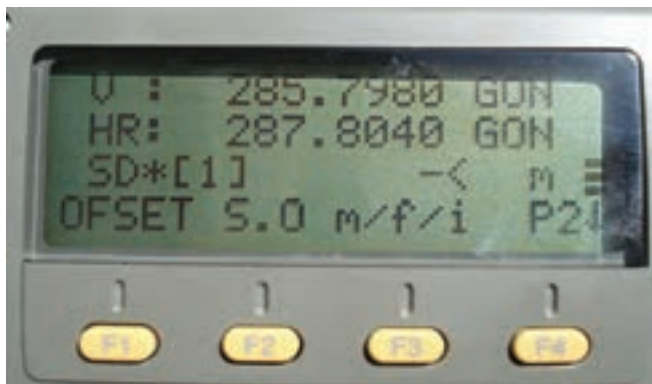
▲ شکل ۳-۵- صفحه دوم منوی طولیابی در توتال استیشن Topcon سری GTS - ۲۲۰
