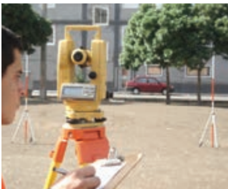
ب) نشانه‌روی و قرائت امتداد سمت راست در حالت دایره به چپ دوربین
