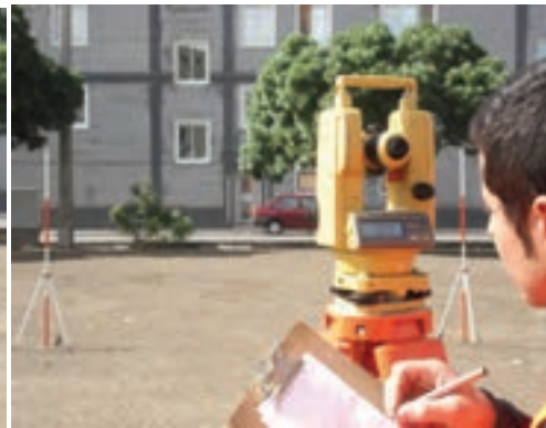
الف) نشانه‌روی و قرائت امتداد سمت چپ در حالت دایره به چپ دوربین
