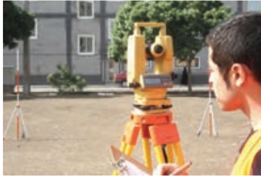
► الف) نشانه روی و قرائت امتداد سمت چپ در حالت دایره به راست دوربین
