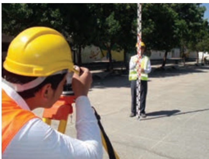
▲ شکل ۱-۷- شبکه‌بندی و برداشت ارتفاع نقاط رئوس شبکه
