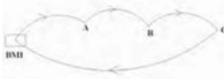
شکل ۱۳ - ۴. کروکی عملیات ترازبایی با کنترل
