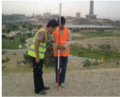
شکل ۲- ۱۴. زاویه صحیح قرائت متر
