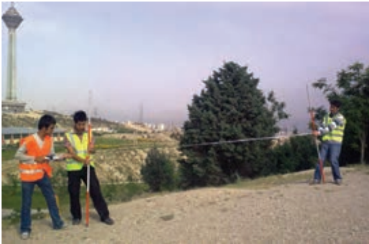
شکل ۲- ۱۱. کشش نامناسب متر
