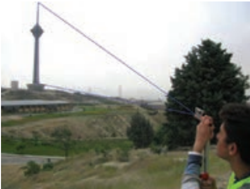
شکل ۱ - ۱۵ . شیب سنج و کاربرد آن
