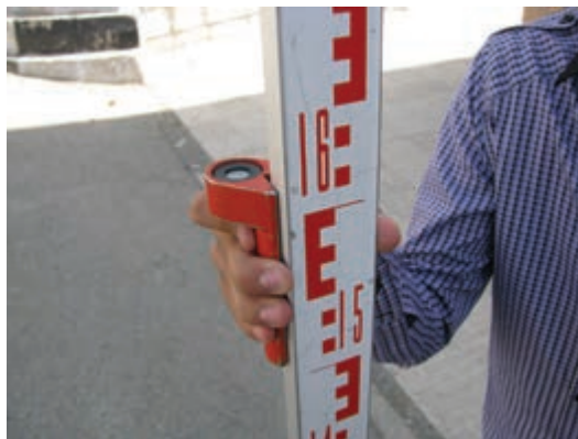
شکل ۱۱ - ۱۰. ننگه داشتن صحیح میر یا شاخص
