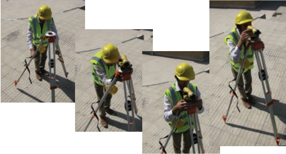
شکل ۱۱ - ۷. مراحل استقرار دوربین تراز یاب
