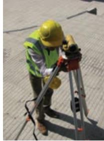
شکل ۱۱ - ۹. تراز کردن دوربین ترازباب
