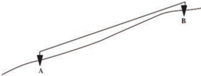
شکل ۳-۴. اندازه گیری فاصله ی مایل AB
