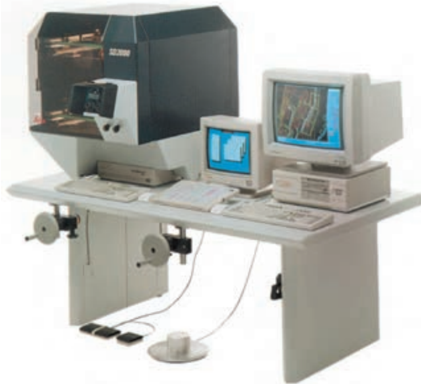
شکل ۱۰-۳- دستگاه تحلیلی تبدیل عکس به نقشه
