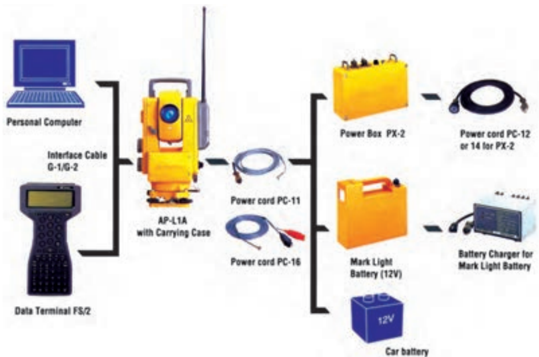
شکل ۲۲-۴- نمایش ارتباط توتال استیشن با تجهیزات جانبی
