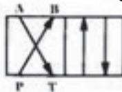
شکل ۱۲-۶- شیر چهارراهه از نوع اسپول‌دار
