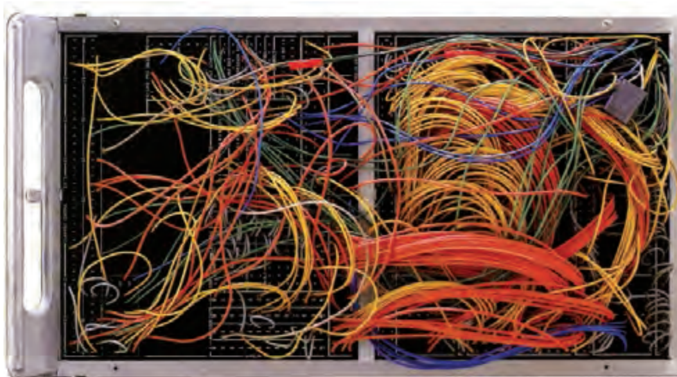
شکل ۶-۶ - پشت یک صفحه کنترل و مدارهای یک دستگاه الکترونیکی، (۵۲/۷ × ۲۹/۲ سانتی‌متر)، ۱۹۵۰- کاربرد رنگ در روکش سیم‌هایی که امروزه در صنایع الکتریکی و الکترونیکی استفاده می‌شوند، یکی از وجوه کاربردهای صنعتی رنگ می‌باشد.
