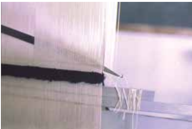
تصویر ۳-۱۸- عبور پود کلفت و شانه
