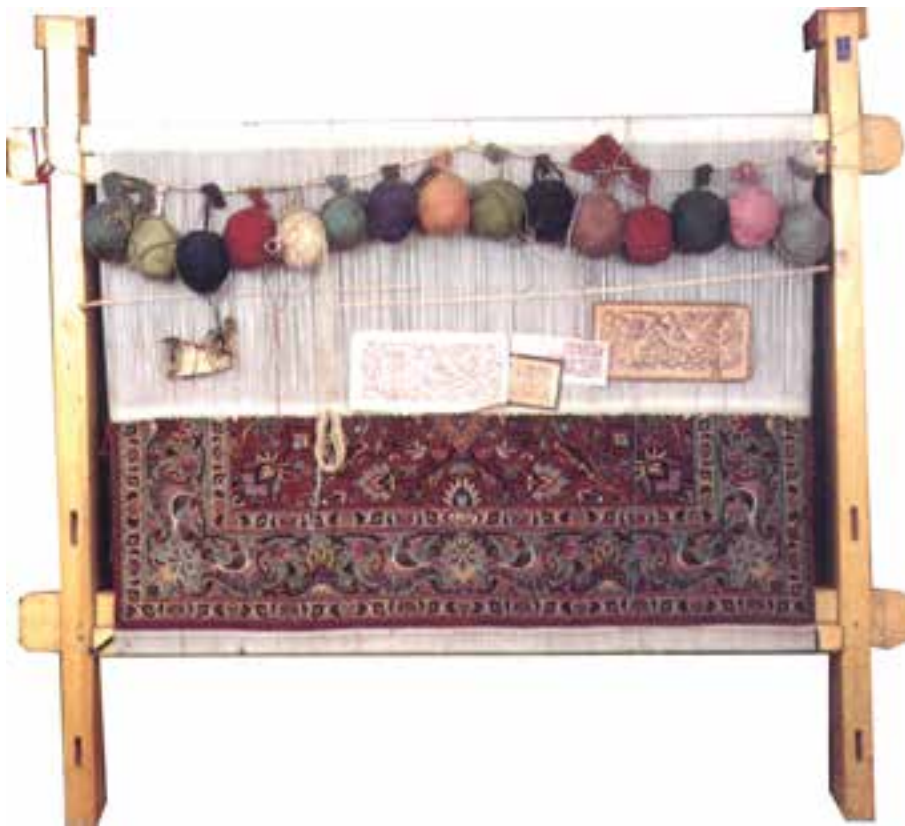
تصویر ۴-۱۲- دستگاه قالی بافی عمودی تبریزی
