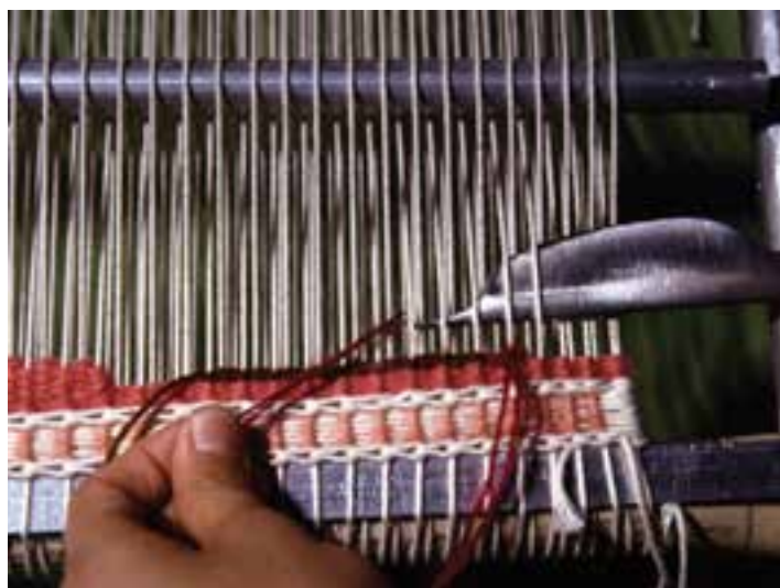
تصویر ۴-۱۰-ب - عبور پود با استفاده از قلاب
