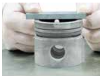
شکل ۶-۸- اندازه‌گیری پیستون با گلوله‌ی اندازه‌گیری
