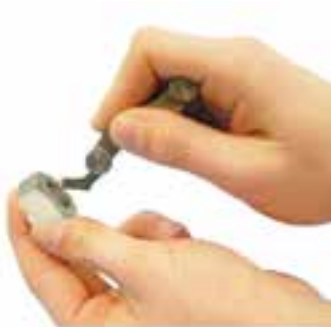
شکل ۱۳-۸- تعیین تعداد دندان‌ها در یک اینچ مهره
