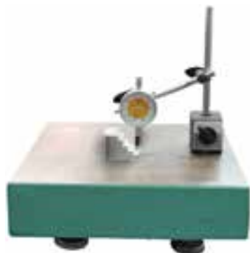
شکل ۱-۶- اندازه‌گیری قطعه‌ی پله‌ای
